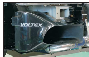
■オイルクーラーダクト(FRP)
